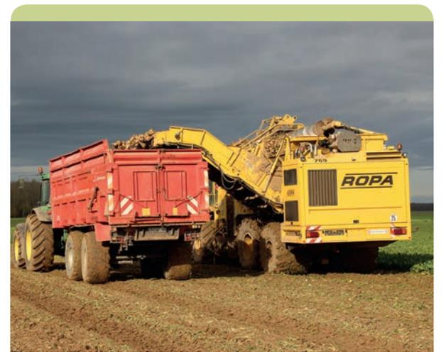
Ne remplir la trémie de l'intégrale qu'à la moitié de sa capacité permet de limiter le tassement.
