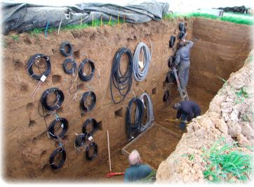
Le dispositif d'Estrées-Mons de **22 hectares** permet de suivre de manière continue les paramètres qui jouent un rôle majeur sur les pollutions et sur la production agricole. Plus de **300 capteurs** permettent d'analyser les pollutions diffusées.
