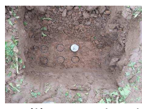
Prélèvement du sol à l'aide de cylindres spécifiques
