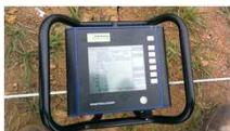
Console du pénétromètre (penetrologger Eijelkamp®) affichage d'une courbe lors de la mesure
