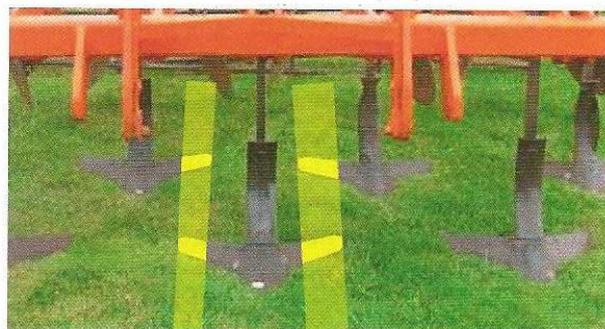
Exemple d'outil avec un recouvrement élevé (en jaune, le recouvrement des dents entre elles).
