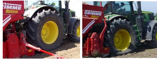
La diminution de la pression de gonflage augmente la surface d'empreinte du fait de l'écrasement du pneumatique.
