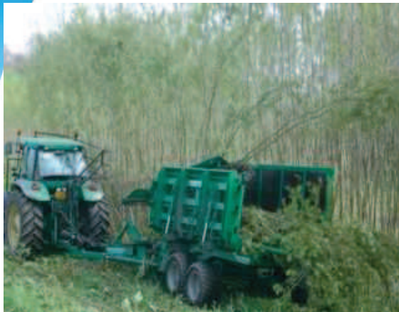
Récolteuse tiges entières Stemster MK III (Nordic Biomass)
