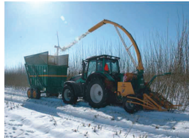
Abatteur - Broyeur embarqué JF Harvester (Ny Vraa)
