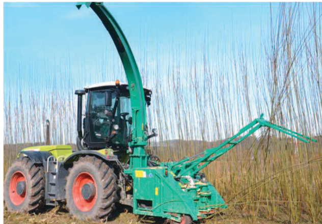
Abatteur - Broyeur embarqué GMHT 140 (Jenz)
