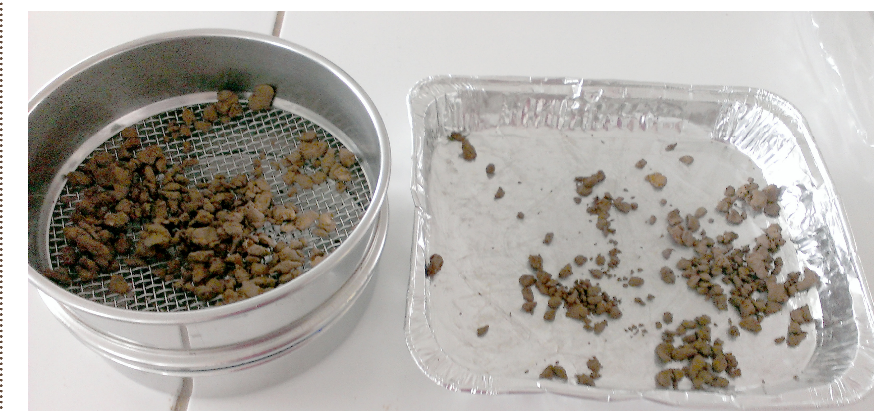
Préparation d'échantillons pour la mesure de l'activité microbienne
