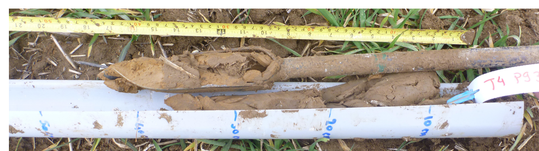
Sondage tarière réalisé dans sol argilo-limoneux
