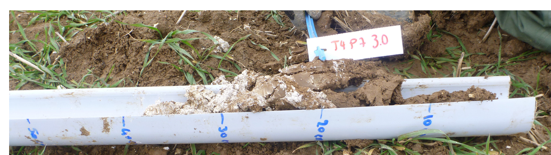
Sondage tarière réalisé dans sol argilo-calcaire
