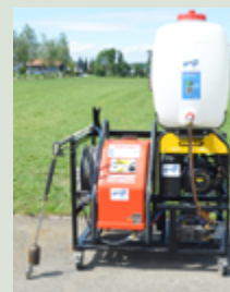
Prototype de l'outil qui applique de l'eau à haute pression
